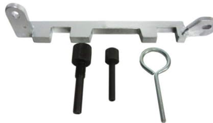
CR-327 A JOGO DE FERRAMENTAS P/ SINCRONISMO MOTOR FORD 303 3 CIL (85 CV) DURATEC FORD KA
