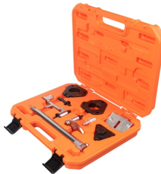
RV-141500 KIT DE FERRAMENTAS P/ TROCAS DA CORREIA DENTADA LINHA FIAT
