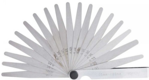
VD-3595100020 CÁLIBRE DE FOLGA 0,05 MM A 1,00 MM, COM 20 LÂMINAS
